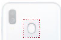
Der Fingerabdrucksensor kann sich auf der Vorder- oder Rückseite des Smartphones befinden oder ist in die Home-Taste bzw. „unsichtbar“ in den Bildschirm eingebaut. Um den Fingerabdrucksensor zu nutzen, muss zuvor der eigene Fingerabdruck bei der Einrichtung des Smartphones gespeichert werden (*weitere Infos in Teil 3 Sicherheit*).
